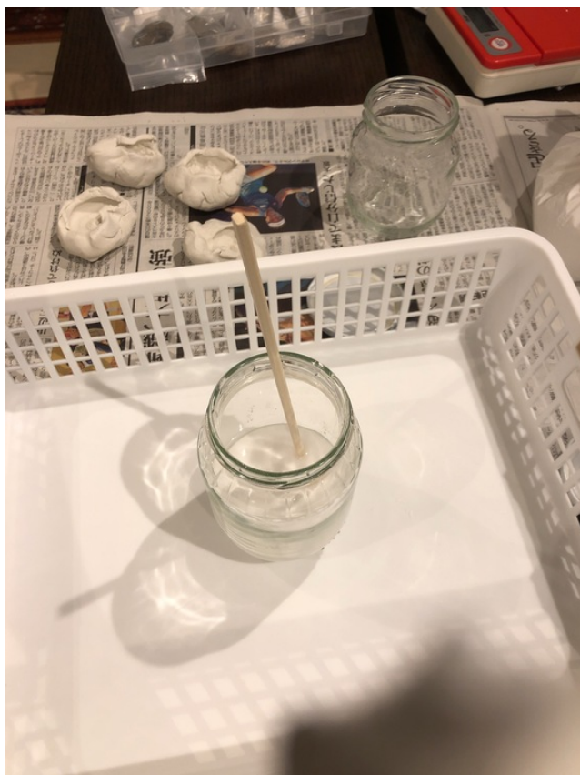
そして石膏を水に溶かして(石膏:水=1000g:740g メーカーによって異なります)、気泡ができないようにかき混ぜてから、型に流し込みます。
